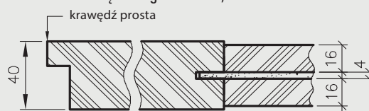
Przekrój poziomy drzwi Ena, Trevi, Verano, Emena i Triesta (przekrój na wysokości łączonego ramiaka)
