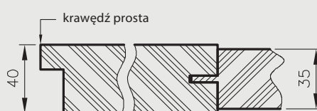
Przekrój poziomy drzwi Scala i Trevi**
