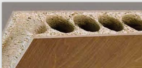
Rys.B. Płyta wiórowo-otworowa
