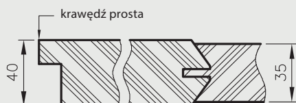
Przekrój poziomy drzwi Elsa
