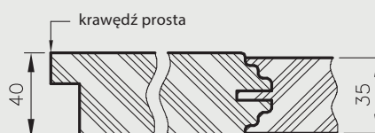
Przekrój poziomy drzwi Nestor, Lexa
