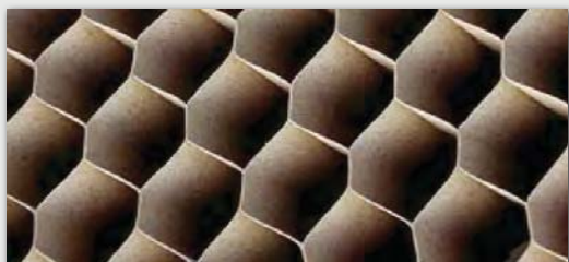
Rys.A. Wkład stabilizujący „plaster miodu”
