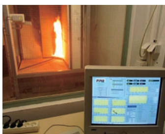
Isover TWINNER při zkoušce SBI – třída reakce na oheň B-s1,d0
