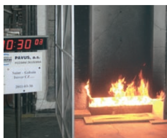
Isover TWINNER a zateplovací systém ETICS ve 4. a 30. minutě zkoušky dle ISO 13785-1 a národní přílohy NA. K šíření požáru ani k odkapávání nedochází.
