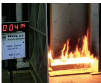
Isover TWINNER a zateplovací systém ETICS ve 4. a 30. minutě zkoušky dle ISO 13785-1 a národní přílohy NA. K šíření požáru ani k odkapávání nedochází.
