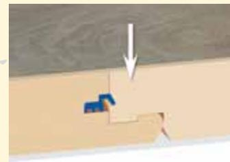
Ein kurzer Druck mit dem Daumen auf die Querfase der Kopfseite, und mit einem hörbaren Klack rastet die neue Diele ein.
