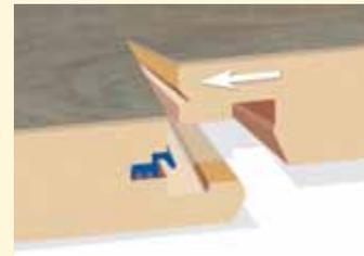
Neue Diele einfach an der Längsnut der bereits liegenden Vorderreihe ansetzen und durch Absenken mit der Laminatreihe verbinden.
