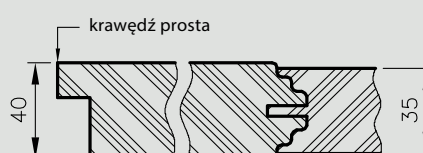
Przekrój poziomy drzwi Nestor
